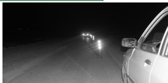
شکل ۱: نحوه اندازه‌گیری روشنایی در چشم رانندگان
