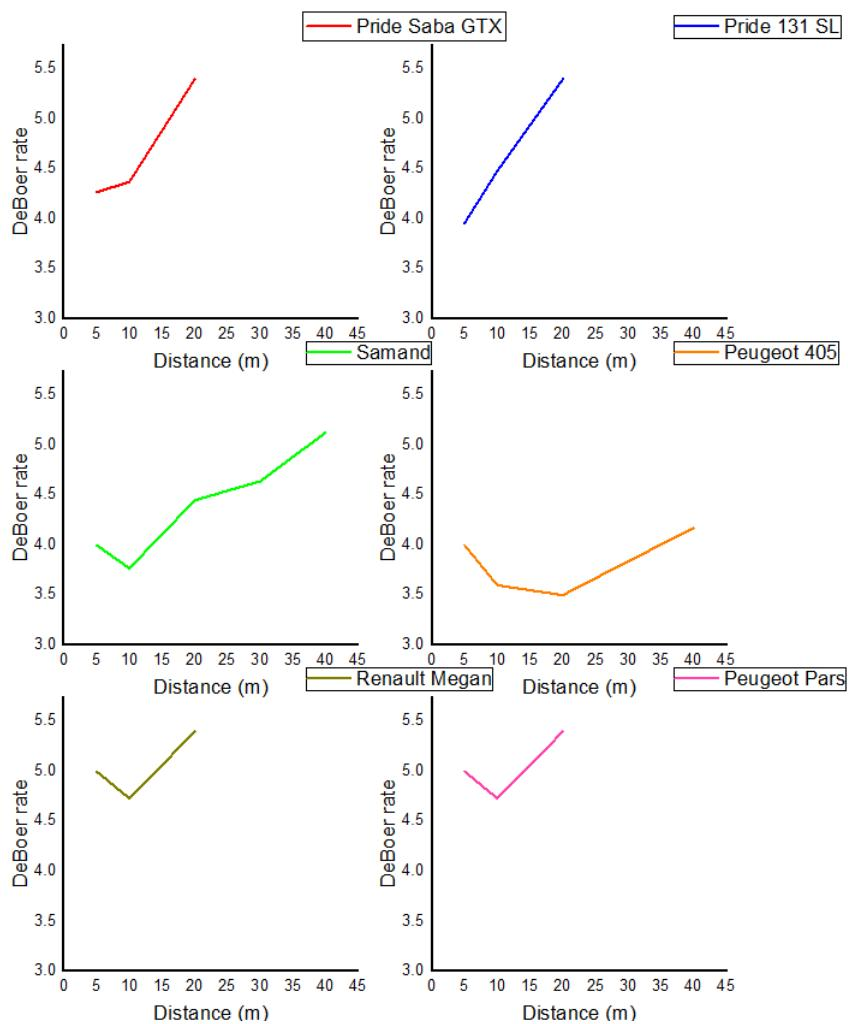
شکل ۵: سطح خیرگی آزاردهنده خودروهای بررسی شده در حالت نورپایین در درخشندگی زمینه ۵۰ کاندلا بر مترمربع
