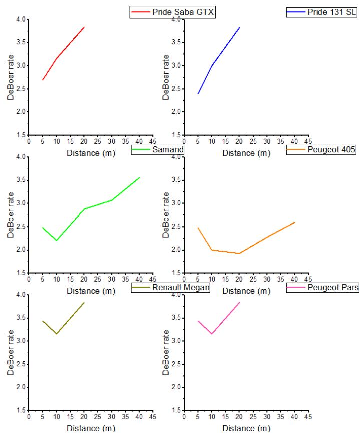
خیرگی افزایش و از این فواصل تا ۵ متری سطح خیرگی آزاردهنده کاهش می‌یافتد. در چهار خودروی پراید ۱۳۱SL، پراید صبا GTX، مکان و پژو پارس افزایش خیرگی آزاردهنده از ۲۰ متری شروع می‌شود و به ترتیب برای این خودروها تا فاصله ۵ و ۱۰ متری به ترتیب افزایش و از این فاصله به بعد سطح خیرگی آزاردهنده کاهش می‌یافتد.
