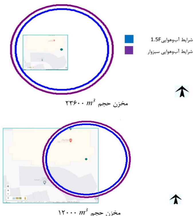
شکل ۷. گستره آتش استخری ثانویه شدت تشعشع 4 \frac{kw}{m^2}
