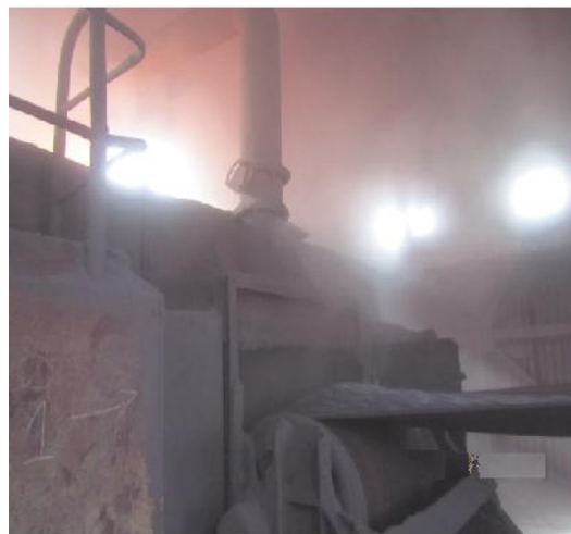
شکل ۲- انتشار غلظت بالای آلاینده در فضای بسته و عدم کارایی هود ۱ شکل ۳- انتشار غلظت بالای آلاینده در فضای باز و عدم کارایی هود ۱۷
