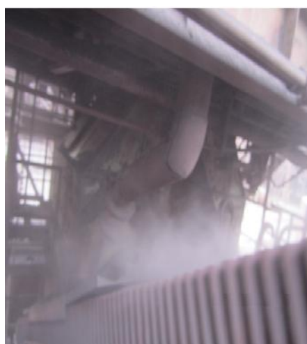
شکل ۲- انتشار غلظت بالای آلاینده در فضای بسته و عدم کارایی هود ۱ شکل ۳- انتشار غلظت بالای آلاینده در فضای باز و عدم کارایی هود ۱۷
