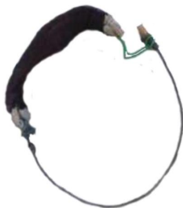
شکل ۲: ابزار سنتی موسوم به پُرَوند برای بالا رفتن از درخت خرما
