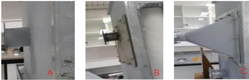
شکل ۲: اشکال ورودی؛ A: ورودی از پایین، B: ورودی از بالا به صورت فلنجی، C: ورودی از بالا با بازشدگی
