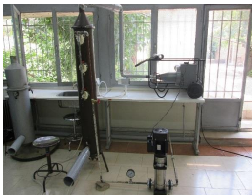
شکل ۱: برج اسپری استفاده‌شده در پژوهش
