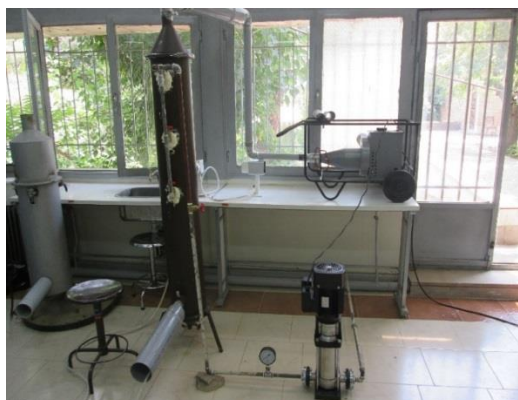
شکل ۱: برج اسپری استفاده‌شده در پژوهش
