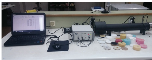
تصویر ۲: لوله امپدانس مدل SW260 شرکت BSWA به همراه نمونه‌های مورد مطالعه
