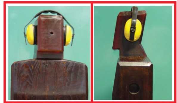
تصویر ۲: نمای آداپتور ساخته‌شده و چگونگی قرار گرفتن حفاظ رو گوشی روی سر
