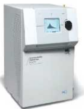
شکل ۴- دستگاه سنجش روبشی اندازه ذره (Scanning Mobility Particle Sizer)
