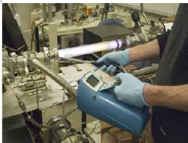
شکل ۳- شمارشگر چگالشی ذره (Condensation Particle Counter) یا CPC
