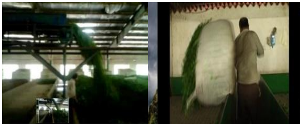
۳- از مداخلات دیگر واحد مالش، نزدیک کردن محل دپو کردن چای به نوار نقاله‌ی انتقال‌دهنده چای به دستگاه مالش است؛ که با طراحی نوار نقاله و اتصال آن به نوار نقاله موجود که برای انتقال چای به دستگاه مالش استفاده می‌شود صورت گرفت.
