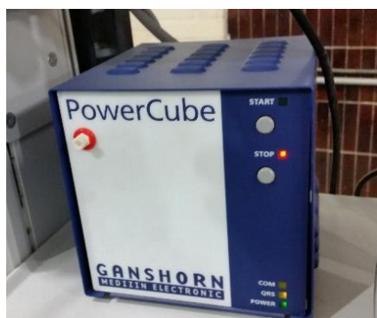
شکل ۱: دستگاه گاز آنالیزور مدل Ganshorn
