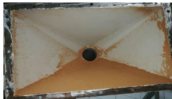
شکل ۳: نشست ذرات در کف ورودی با بازشدگی
