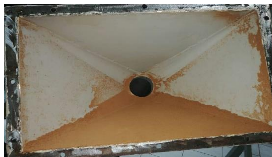
شکل ۳: نشست ذرات در کف ورودی با بازشدگی
