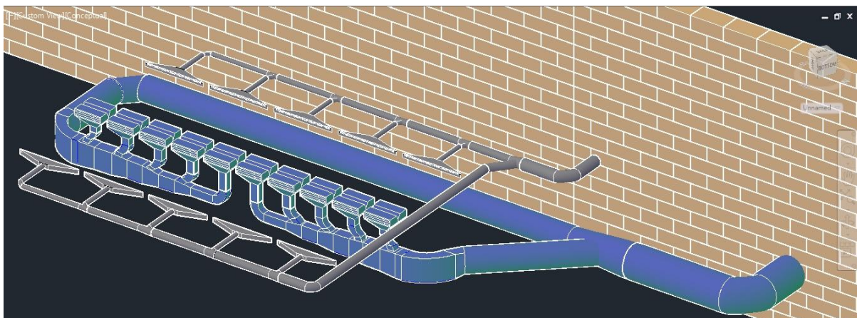
تصویر ۳: نمای کلی از سیستم تهویه دمشی-مکشی اجرا شده بدون وان‌ها
