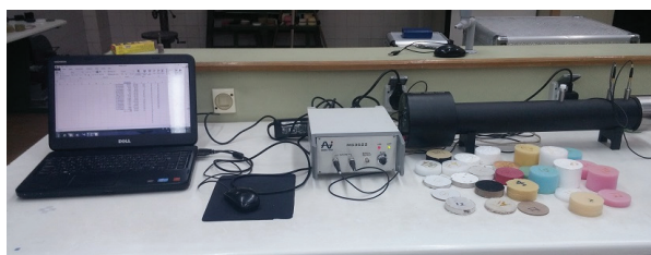
تصویر ۲: لوله امپدانس مدل SW۲۶۰ شرکت BSWA به همراه نمونه‌های مورد مطالعه
