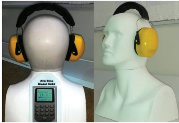
تصویر ۲: تعیین قدرت کاهندگی صدای گوشی با استفاده از مانکن سر مطابق با استاندارد ISO ۳-۴۸۶۹
