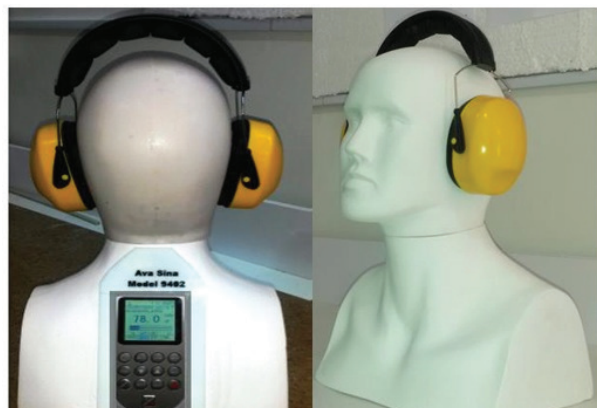
تصویر ۲: تعیین قدرت کاهندگی صدای گوشی با استفاده از مانکن سر مطابق با استاندارد ISO ۳-۴۸۶۹
