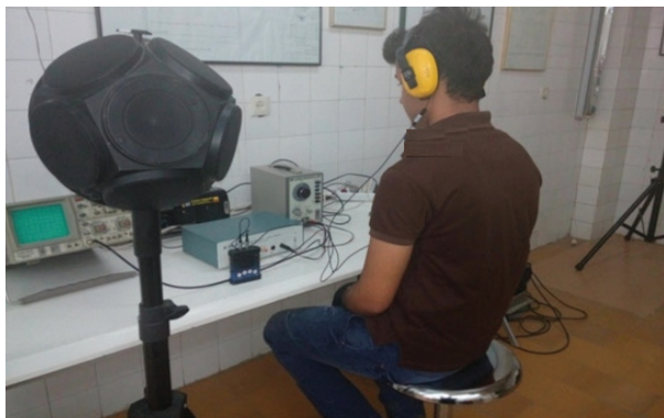
تصویر ۱: تعیین قدرت کاهندگی صدای گوشی بر روی افراد مطابق با روش استاندارد ISO ۱۱۹۰۴
